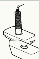
XPTH 14 74 T        | 597468      | Dual Beam, 20/74° 200/50 kHz, mit Temperatursensor                                                            | ION Serien* ONIX10ci Combo* ONIX8ci Combo* *Benötigt ein Sonarmodul                                       |
